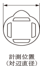
図 竹刀の先革長、先革先端部最小直径値、ちくとう直径値の計測方法
